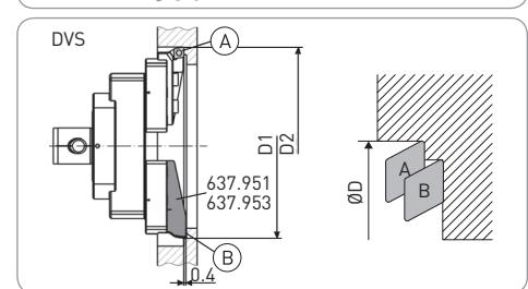
(Schneide ④) wird ein langer Wendeplattenhalter benötigt. Die langen Wendeplattenhalter sind schwarz gefärbt und einzeln erhältlich. Schneide ④ auf den Aussendurchmesser und Schneide ⑤ auf die Hälfte der Materialzugabe einstellen.
