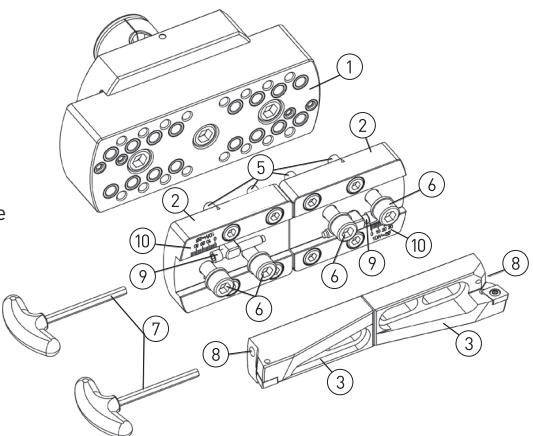
Le tableau définit les composants comme la semelle ①, les pièces de fixation ② et les porte-plaquettes ③ pour toutes les plages de diamètres et indique en quelle position les pièces de fixation ② doivent être montées sur la semelle ①.
