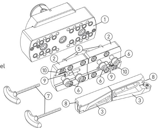
La tabella stabilisce i componenti per ogni intervallo di diametro, come slitta ①, elementi intermedi ② e porta-inserti ③, inoltre mostra in quale posizione si devono montare gli elementi intermedi ② sulla slitta ①.
