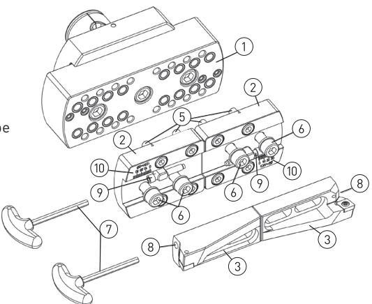
Die nachstehende Tabelle bestimmt die Komponenten wie Zwischensohle ①, Zwischenkörper ② und Wendeplattenhalter ③ für jeden Durchmesserbereich und zeigt auf, in welcher Position die Zwischenkörper ② auf der Zwischensohle ① montiert werden müssen.
